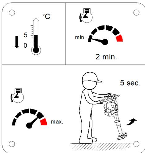
Wird der Stampfer bei Temperaturen unter 5° Celsius verwendet, muss das Öl im Stampfsystem kurz erwärmt werden. Dazu:
