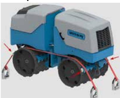
Soll die Maschine niedergezurt werden, muss dies über die Bandagen erfolgen. Um Beschädigungen der Abstreifer zu verhindern, müssen diese Wahlweise demontiert oder unter Zuhilfenahme von Holzkeilen auf den Bandagen abgestützt werden.
