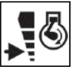
Der Wählschalter Motordrehzahl schaltet den ECO-Modus ein oder aus.
