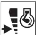
Zum genauen Rangieren der Maschine ist es möglich, sie auch dann zu fahren, wenn der Motor auf Leerlaufdrehzahl läuft. Die Vibration steht im Leerlaufbetrieb nicht zur Verfügung.
